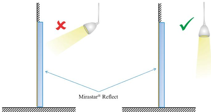
**MIRASTAR® REFLECT no está diseñado para el montaje en UVA ni laminado. Para aplicaciones interiores como revestimientos de paredes, frentes de cocina, etc., recomendamos colocar la capa frente al soporte para facilitar la limpieza.** Para más información, póngase en contacto con su Responsable de Asistencia Técnica.
